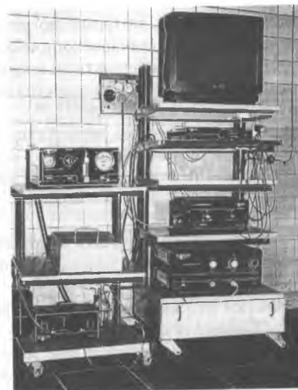
Рис. 171. Видеоэндоскопическая стойка фирмы «Эндомиум»
