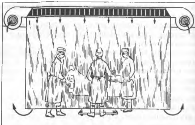
Рис. 148. Бокс-изолятор с ламинарным потоком воздуха, устанавливаемый в операционной
