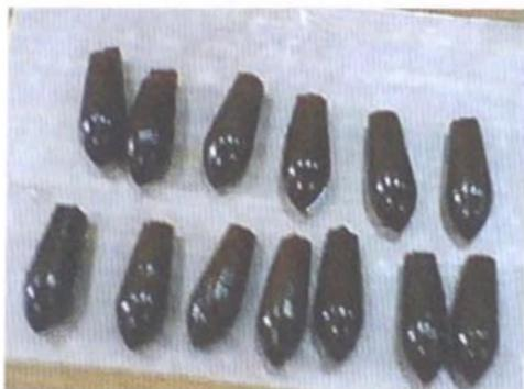
**Рис. 9.3.** Готовые суппозитории, полученные выливанием
