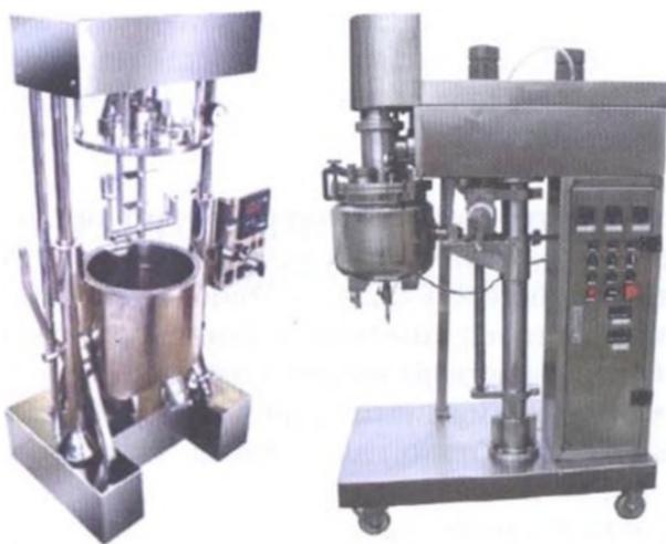
Рис. 6.1. Гомогенизаторы различной конструкции
